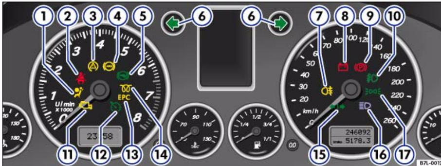
**Илл. 19** Расположение сигнальных и контрольных ламп. Некоторые из представленных здесь сигнальных и контрольных ламп имеются только на определенных исполнениях автомобиля или устанавливаются в качестве заказного оборудования.
