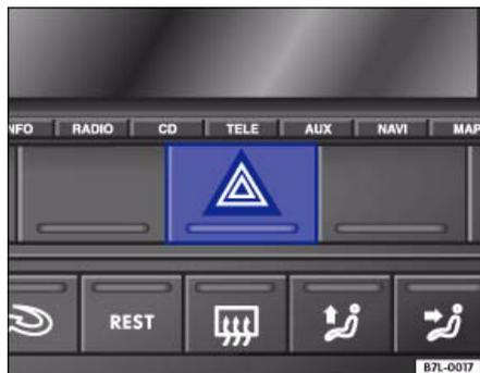
**Илл. 37** На передней панели: выключатель аварийной сигнализации
