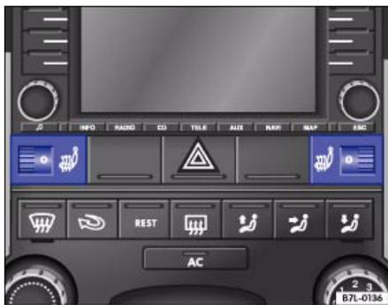
**Илл. 54** В передней панели: выключатели-регуляторы обогрева передних сидений
