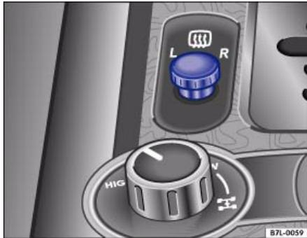
**Илл. 42** На центральной консоли: поворотная кнопка для регулировки положения наружных зеркал
