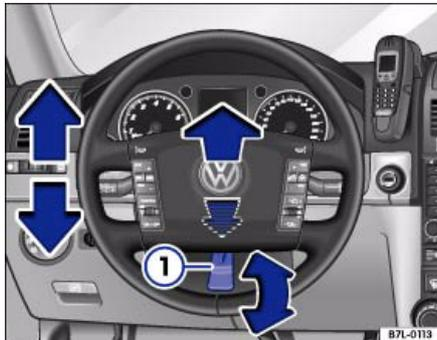
**Илл. 51** Рычаг 1 для ручной регулировки положения рулевого колеса
